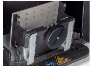
Schieben Sie die Bauplattform mit dem Druckobjekt auf die Abtropfphasen, so dass das Material abfließen kann.
