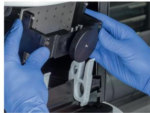
Nehmen Sie die Bauplattform mit dem Druckobjekt aus der Befestigung.
